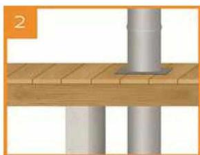
В основном отапливаемом помещении могут быть применены одноконтурные трубы. В случае прохождения дымоходной трубы через стеновые перекрытия, для обеспечения пожарной безопасности, необходимо применять трубы - сэндвичи (двухконтурная труба), изолированные потолочно-проходным узлом (ППУ) и негорючими материалами.
