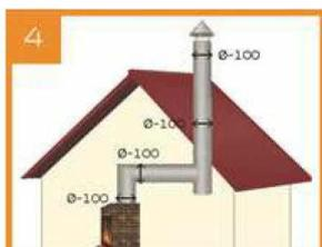
Диаметр дымового канала должен соответствовать мощности аппарата и на всем протяжении не должен быть менее диаметра выпускного патрубка аппарата.
