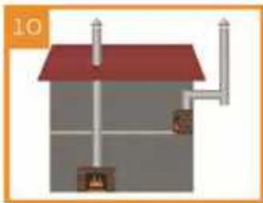
Для каждого теплогенерирующего аппарата следует устраивать собственный дымоходный канал.
