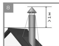
Крепление элементов систем дымоходов к строительным конструкциям должно осуществляться с помощью консолей (кронштейнов настенных) и опорных площадок не реже, чем через каждые 4 метра. Крепление соединительных труб должно исключать возможность прогиба.
