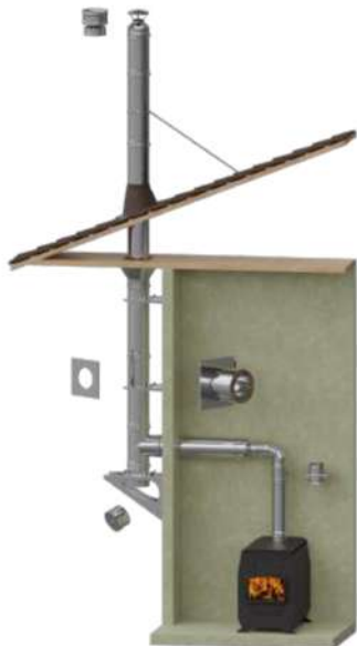
Для котла/печи вдоль наружной стены
